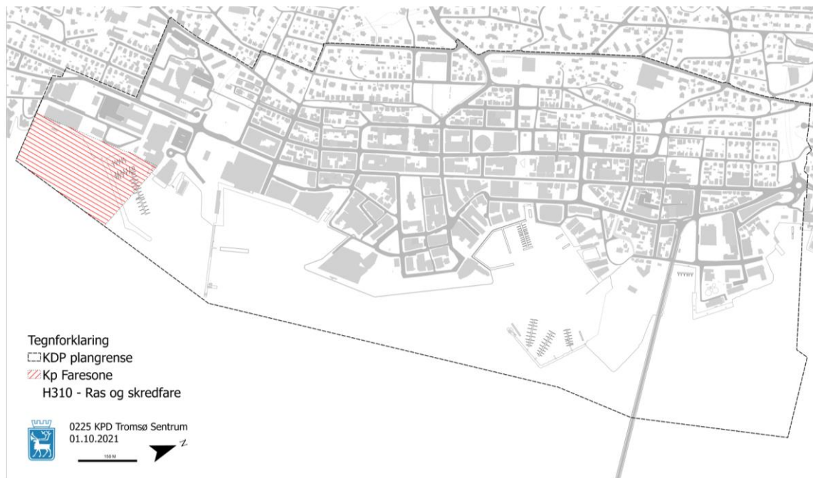
Figur 97 utfylling i Sørbyen er avsatt som hensynssone for å markere behovet for grunnundersøkelser som pr i dag ikke er utført.
