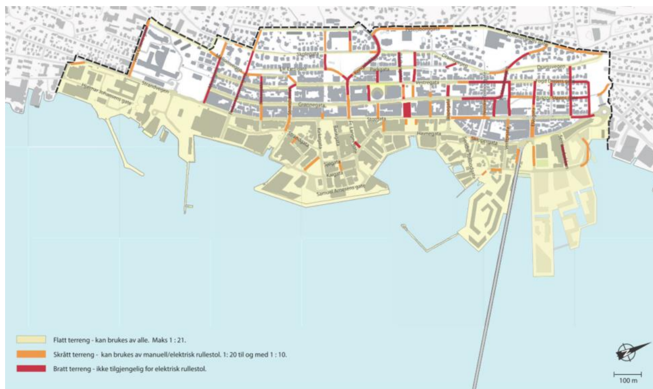
Figur 73 Temakart - Terreng i Tromsø Sentrum. Kartet er unøyaktig da det bygger på feil premis for elektrisk rullestol ute. Det betyr bl.a. at Storgata til Grønnegata skal være rødt, altså bratt terreng. Tromsø kommune POR 2020.
