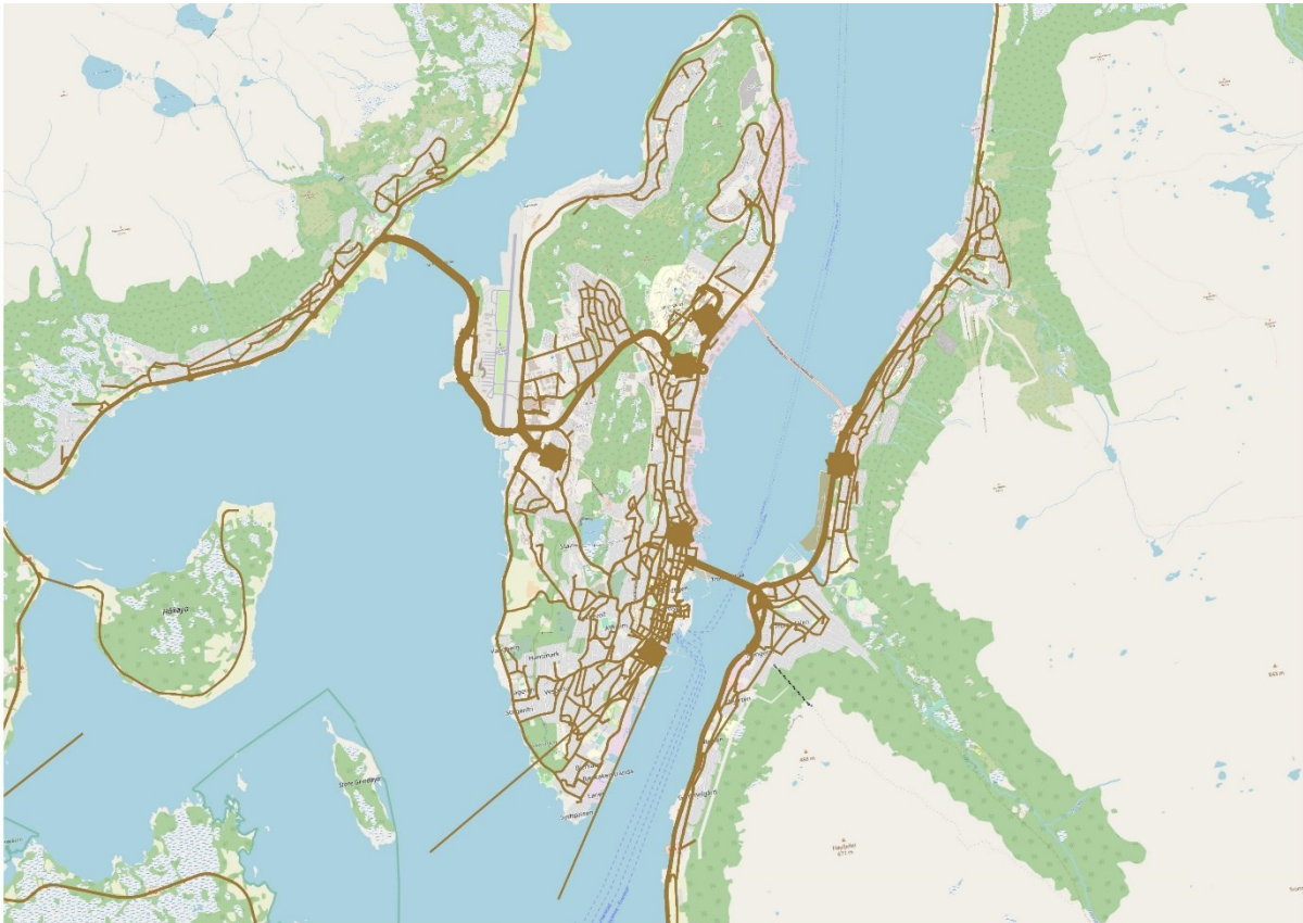
Figur 3-6: Utslippsberegninger for PM10 fra lette biler per veilekke i modellen. Tykkelsen på linjene angir kvalitativt intensiteten (gram per meter per år) til utslippet fra veien
