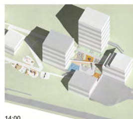
Illustrasjon: Avtrapping av de to øverste etasjene i den sørligste blokka den 20. juni.
